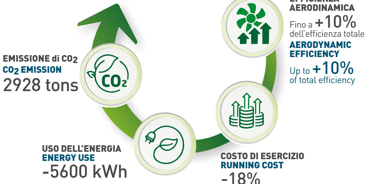
Il confronto prende in esame un VA 904 con un ventilatore assiale di pari diametro e di costruzione convenzionale. Tempo di utilizzo considerato: 2.000 ore di funzionamento all'anno. Fattore di conversione da kWh a Kg di CO<sub>2</sub> pari a 0,523.
